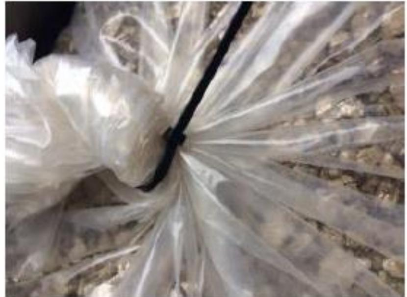
Vor dem Verschließen des Inlay- Kunststoffesackes: Li-Batterien mit Vermiculite abdecken, fest verschließen des Sackes (z.B. mit Kabelbinder, Klebeband)
