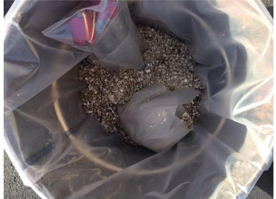
Beschädigter Akku in Kunststoffbeutel in Vermiculite
