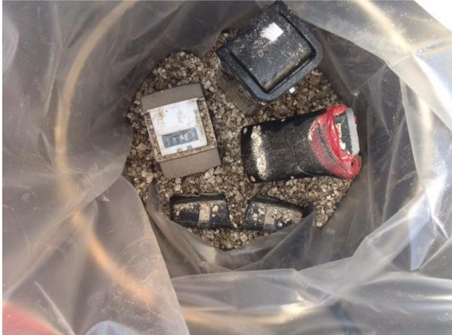
Intakter Akku mit abgeklebten Kontakten
