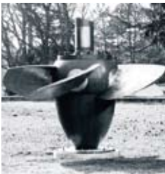
Kaplanturbine für Laufkraftwerke (Demonstrationsobjekt vor dem TMW)
