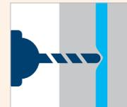
Kabelschaden durch Bohrung/Nagel
